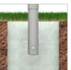
Variant 2: Staanders in beton gegoten, in hoogte verstelbaar tot 25 cm
